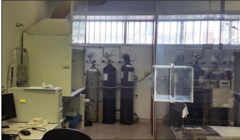
**Não conformidade: Cilindro armazenado dentro do laboratório**
