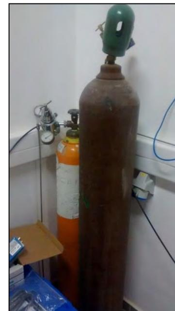
**Cilindros dentro do laboratório e sem correntes**
