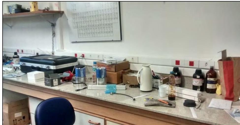
Não conformidade: Bancada do laboratório com reagentes químicos armazenados de forma inadequada
