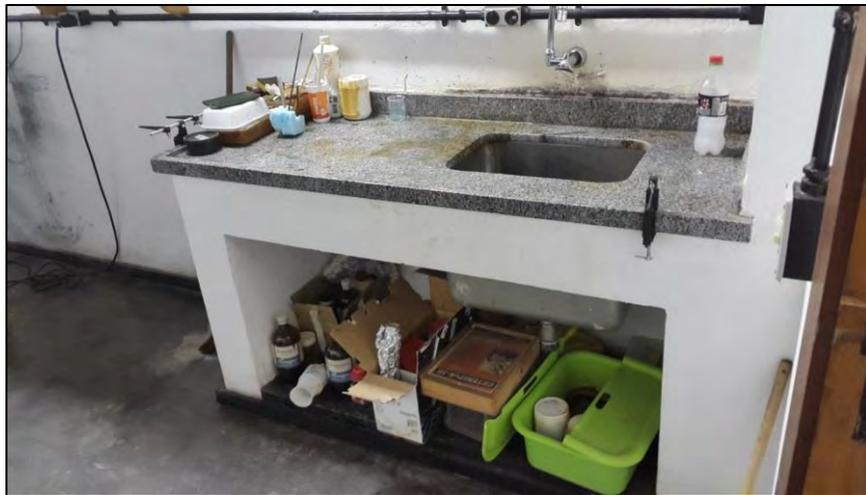
**Pia para corrosão de placas de circuito impresso**
