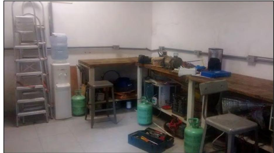
**Cilindros e ferramentas em local inadequado**
