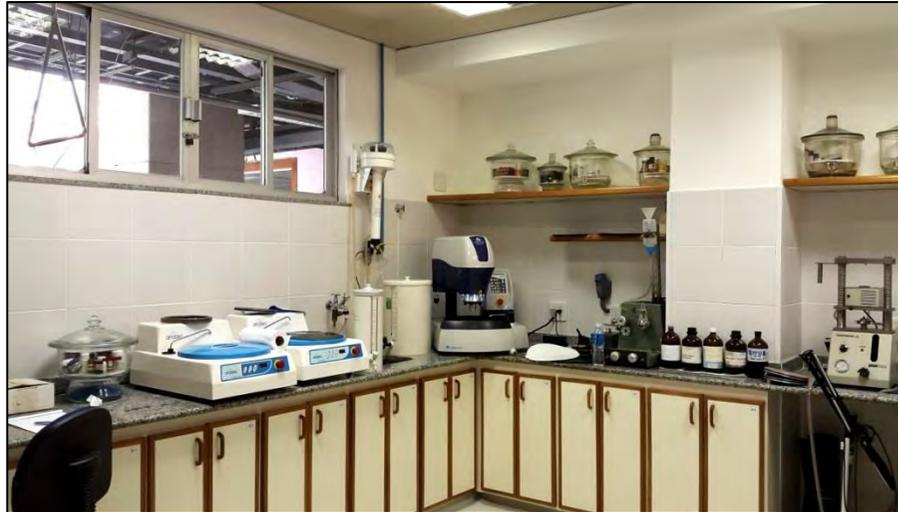
**Não conformidade: Bancadas do laboratório com reagentes químicos armazenados de forma inadequada**
