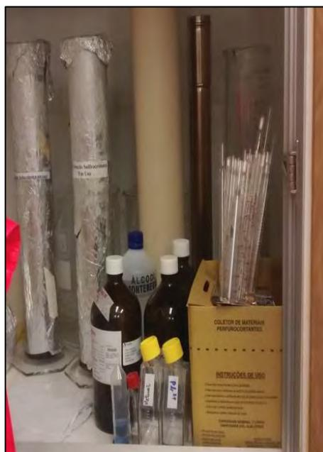
Produtos químicos sem a rotulagem adequada e armazenados de forma inadequada.
